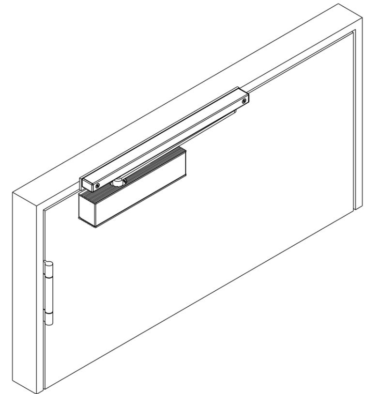
**Anbauvariante Adaptionprofil (ADP 30) und Montageplatte**
